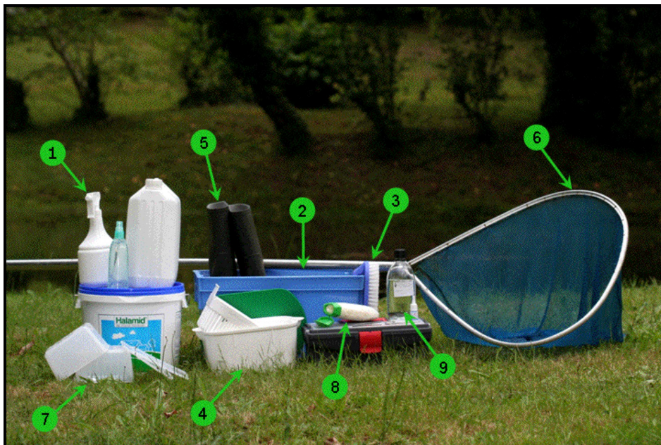
Figure 1 : Matériel de terrain typique. 1) solution désinfectante d'Halamid® 2 % ou de Virkon® 1 % en bidon et/ou en pulvérisateur ; 2) bac pour le nettoyage et le rangement du matériel ; 3) brosse ; 4) bac de trempage ; 5) bottes ; 6) épuisette – en cas de manipulation d'amphibiens ; 7) bacs individuels de contention ; 8) gants jetables ; 9) éthanol à 70 %, briquet et colle chirurgicale Vetbond®.
